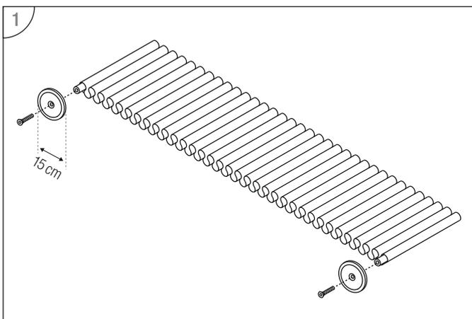
Die Tellerfüße werden von der mit Filz bestückten Seite aus mit den beiliegenden Senkkopfschrauben in den Standrohren verschraubt.
