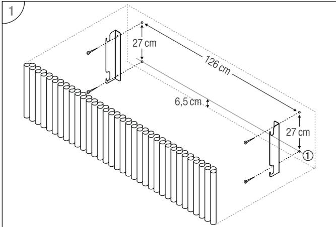
Das erste Bohrloch der Wandhalterung ① wird 6,5 cm oberhalb der gewünschten Unterkante des Filzelements gesetzt. Der vertikale Abstand der Bohrungen beträgt 27 cm, der horizontale Abstand beträgt 126 cm.
