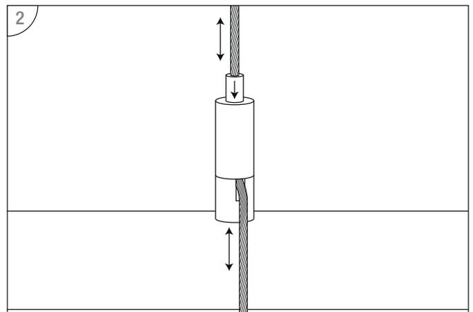
Die Länge der Seile kann reguliert werden indem man die obere Seilaufnahme gedrückt hält und dabei das Seil durch den "Reutlinger" zieht. Überschüssiges Seil kann entweder abgeschnitten, oder im Element verborgen werden (Gesamtlänge Seil: 500 cm / Seil).
