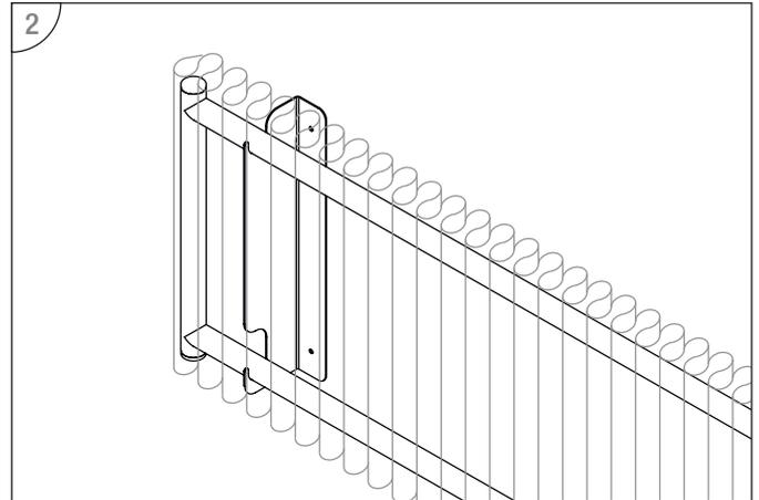
Nach erfolgter Wandmontage mit geeigneten Schrauben bzw. Dübeln werden die horizontalen Rohre des Elements in die Wandhalterungen oben und unten eingehängt. Die Nähte des Filzelements sollten dabei zur Wand zeigen.
